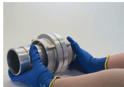
Kupplungen gegenseitig bis zum Anschlag verdrehen. Mutually twist the couplings until they stop.
