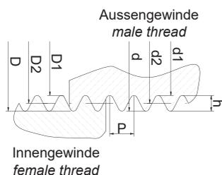
Laut Maßtabelle haben Gewinde nach DIN 2999 und DIN ISO 228 die gleichen Maßwerte, jedoch sind die Toleranzen bei DIN 2999 im unteren Bereich bei Innendurchmesser bzw. im oberen Toleranzbereich bei Außendurchmesser. Es kann daher vorkommen, dass zylindrische Außengewinde nach DIN ISO 228 sich nicht in Teile einschrauben lassen, deren Innengewinde nach DIN 2999 gefertigt wurden.
