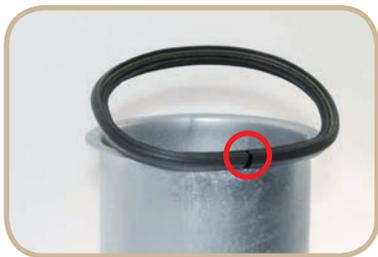
Den Dichtring leicht aufdrücken. Bei der Montage zeigt die profilierte Seite des Dichtrings zur Verbindungsstelle. Begonnen wird mit der Nahtstelle des Dichtringes.
