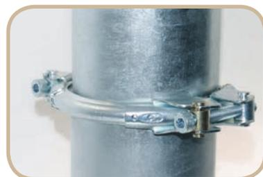
Den Zuganker einhängen und die Schrauben gleichmäßig fest anziehen. Bei ordnungsgemäßer Montage entsteht eine elektrisch leitende Verbindung.
