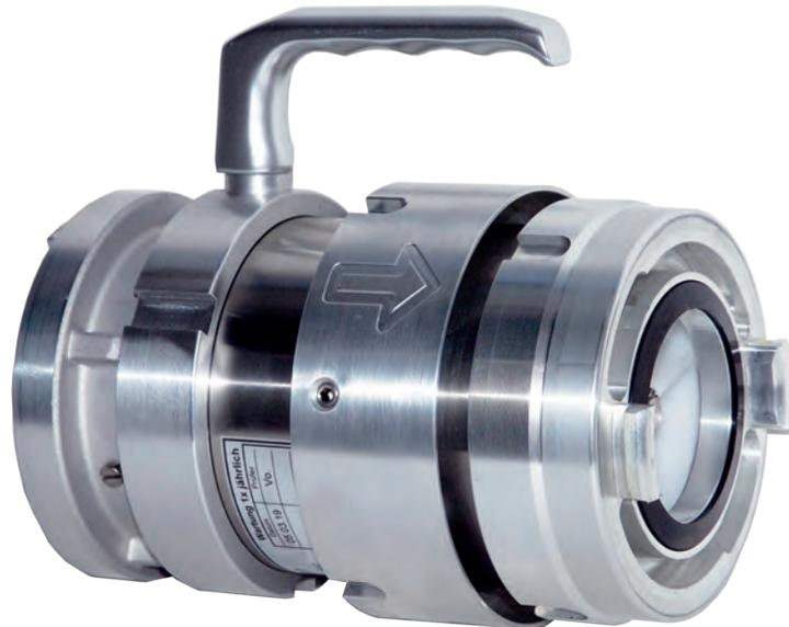
Der Systemtrenner B-FW Typ „F2“ nach DIN 14346 mit einem Durchfluss von 1600 l/min bei einem Druckabfall unter 1 bar
